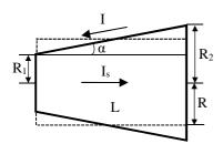
При малых углах  $\alpha$ , см. рисунок, между образующими конуса и его осью, создаваемое силой Ампера давление на коническую поверхность будет мало отличаться от давления на цилиндрическую поверхность, обозначенную на рисунке пунктирными линиями, что даёт возможность приближённой оценки силы тяги эмдрайва. Текущий внутри конуса ток смещения  $I_s$  равен текущему по боковой поверхности току проводимости I; примем, что высота
